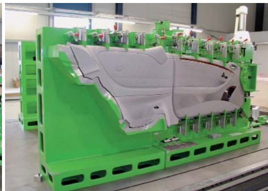
Am Meisterbock (links) und weiteren Lehren werden Fahrzeugteile in ihrer originalen Position montiert, um die Verhältnisse möglichst real zu simulieren.
