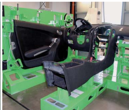
Am Meisterbock (links) und weiteren Lehren werden Fahrzeugteile in ihrer originalen Position montiert, um die Verhältnisse möglichst real zu simulieren.
